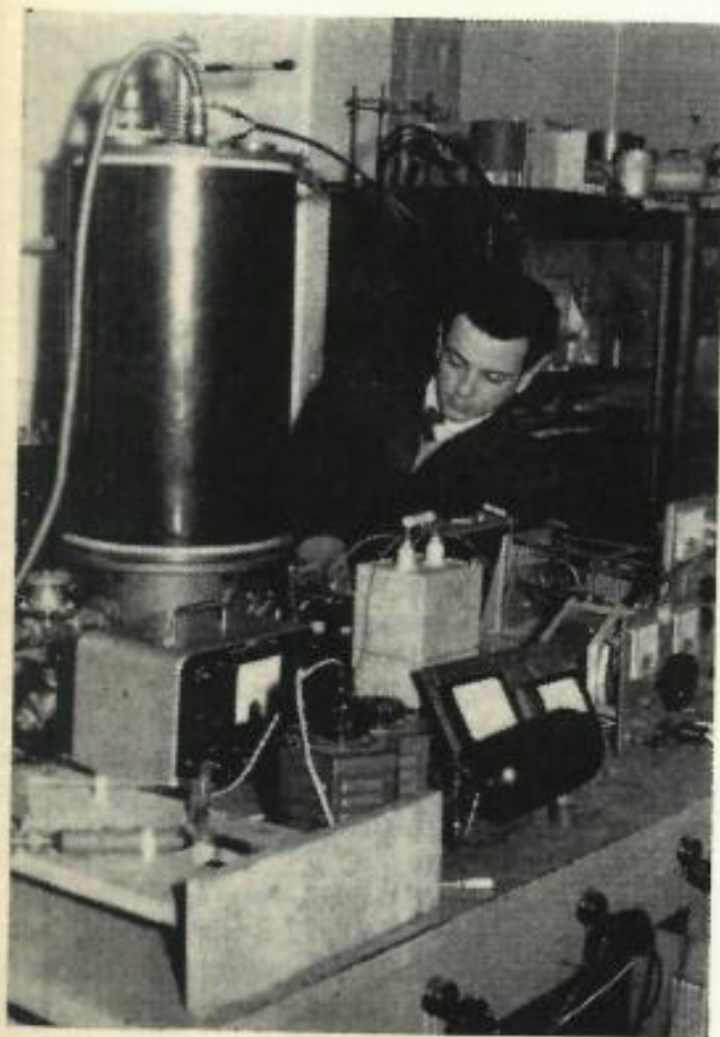
Una nueva fuente de iones que se está construyendo para los trabajos de física nuclear
